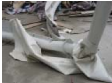
图 7 因支承结构整体倾覆造成膜材撕裂
