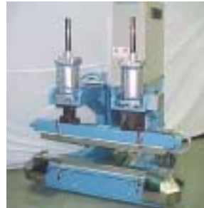
图 20 用于 PTFE 膜高温热合的设备
