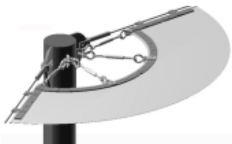
图 10 膜角挖弧处理
