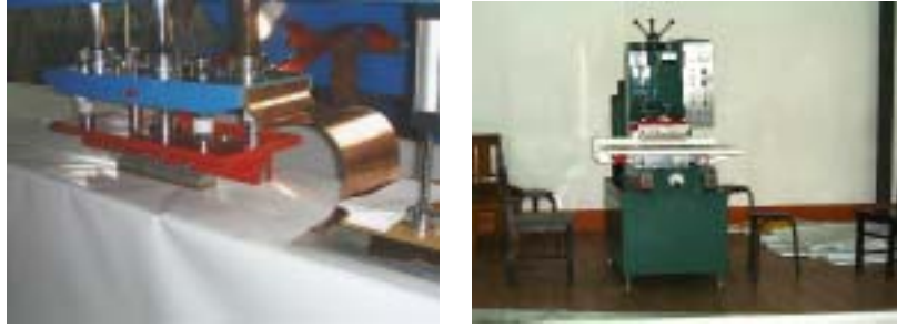
图 21 用于 PVC 膜材高频焊接的设备
