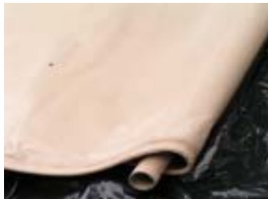
图 22 PTFE 膜折叠时衬入圆纸筒
