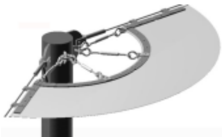
图 10 膜角挖弧处理
